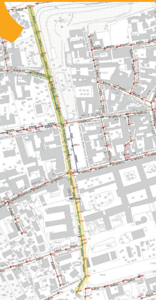
Risanamento condotta fognaria del Comune di Abbiategrasso, lunghezza totale condotta risanata: 550 metri, tubazioni DN 500 e OV 800x1200, tipo di tecnologie utilizzate: Bypass Aereo e CIPP UV Liner, durata dell'intervento: 16 settimane
